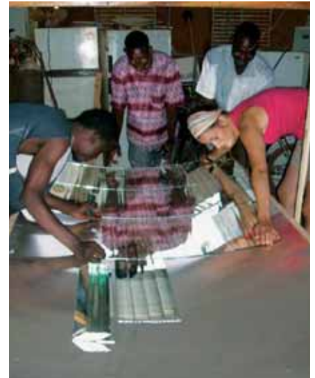
Réalisation de la parabole, permettant de concentrer les rayons du soleil pour produire l'énergie nécessaire à l'extraction des huiles essentielles
