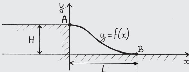
Pour éviter les secousses, on demande que le profil  $y = f(x)$  de cette rampe (qui s'étend de  $A$  à  $B$ ) ait une tangente horizontale aux points  $A$  et  $B$ .
